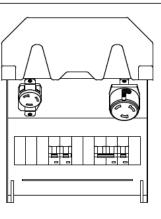
30A 125V TWIST-LOCK 50A 125/250V TWIST-LOCK 30mA GROUND-FAULT PROTECTION
